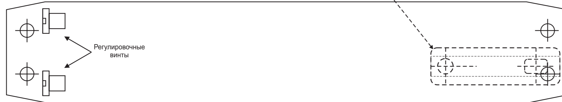
Установка доводчика на короб двери
